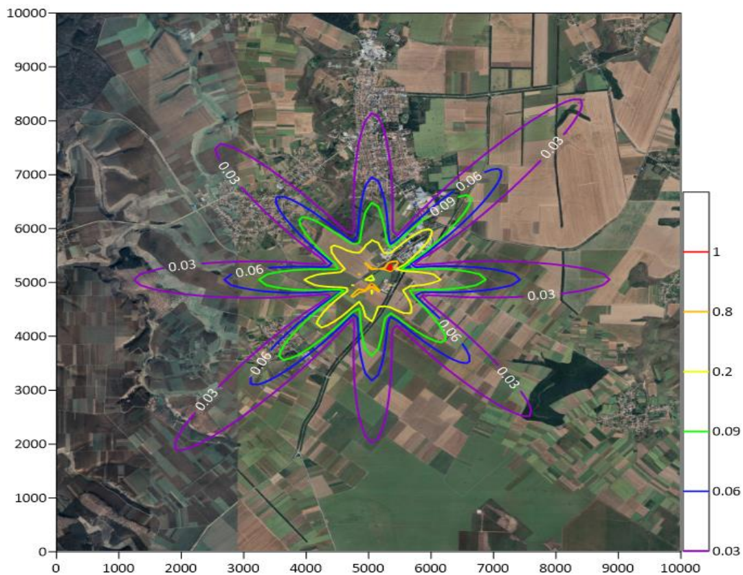
Фигура 4.2-2 Изолинии на средногодишната концентрация на ФПЧ 10 в приземния слой на атмосферата, \mu\text{g}/\text{m}^3
